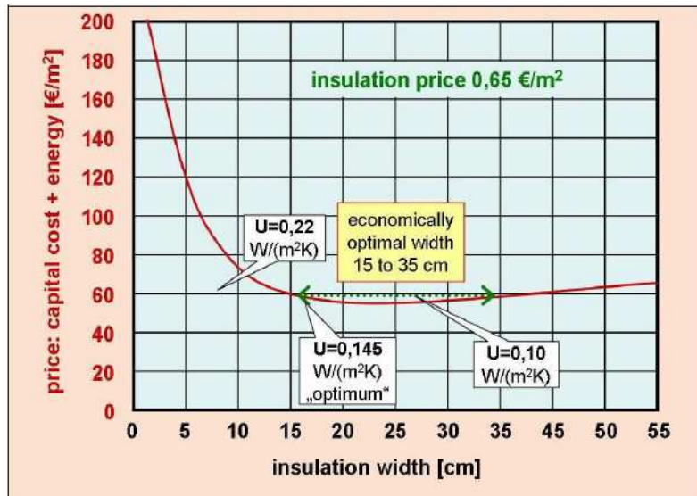
Abbildung 6: Kostenvergleich der Wärmedämmung, Eingangskosten und Mengen der verbrauchten Energie nach 25 jähriger Lebensdauer mit einbezogen. Hier liegt das wirtschaftliche Optimum bei 24 cm. (Quelle: PHI)
